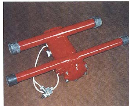
Водолазный автономный искатель ВАИ
