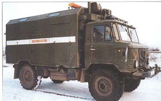
Подвижная электролаборатория ПЭЛ-10 кВ
